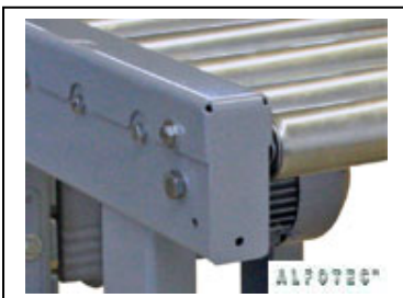
Seitenprofil RTA Antriebsseite aus gekanteten Blechen, 3mm stark, in Kastenform
