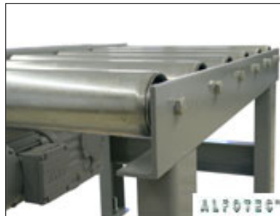
Seitenprofil AU120 Nichtantriebsseite aus Winkelprofil
