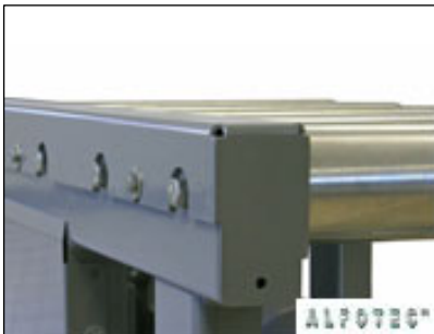
Seitenprofil AU120 Antriebsseite aus gekanteten Blechen, 4mm stark, in Kastenform
